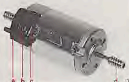
Bild 3 LGB-Hochleistungsmotor a) Herausgezogener Isolierkopf mit b) Führungskanal für Motorkohlen c) Drossel-Spulen zur Funkstörung d) Zweigängige Getriebeschnecke. Motor-Leistungsdaten (Durchschnittswerte) Drehmoment M_d = 0,4-0,6 \text{ Ncm}^* Drehzahl n = 7000-11000 \text{ U/min} Stromaufnahme J = 300-500 \text{ mA} Leistung P_{ab} = 3-7 \text{ Watt} Motor-Wirkungsgrad \eta = 67\% Alle Meßwerte bei mittlerer Zugleistung mit 10 Wagen in der Ebene. * (1 Newton ca. 100 g)
